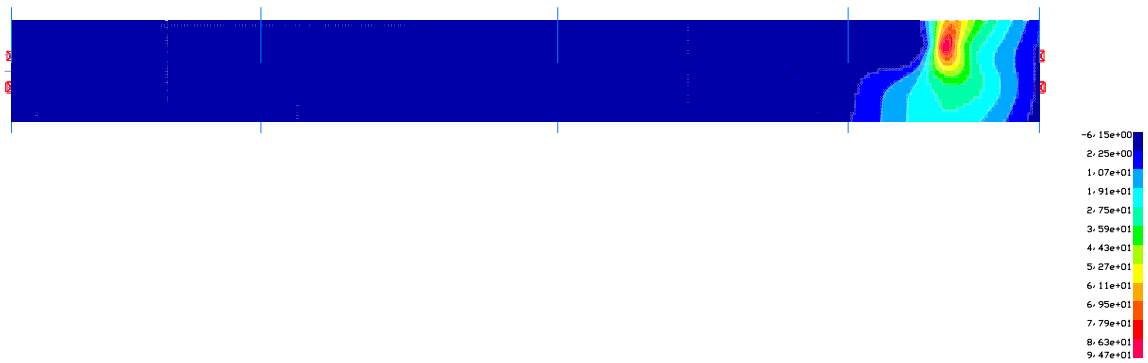
Abbildung 49: Einflussfläche – Elementschnittgröße m_x – Messquerschnitt MQ 3, Messtelle „MQ_3_Ms_U_Li_Int_u“
