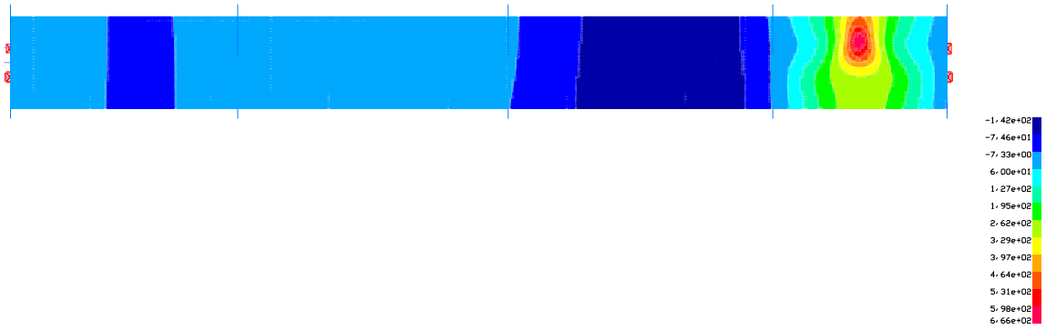
Abbildung 48: Einflussfläche – Elementschnittgröße n_x – Messquerschnitt MQ 3, Messtelle „MQ_3_Ms_U_Li_Int_u“
