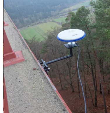
SENSORAUFBAU MIT NEIGUNGSSENSOR
