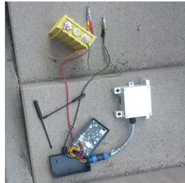
SENSORAUFBAU MIT NEIGUNGSSENSOR
